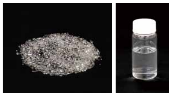
来自纤维素的生物质塑料（聚乳酸） 源自纤维素原料的糖液
